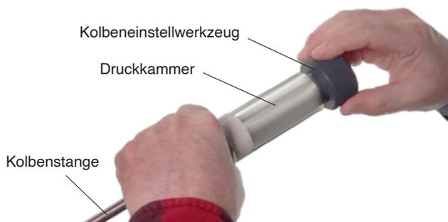
7. Stecken Sie die Kolbenstange durch das Sammlergehäuse und schrauben Sie das Sammlergehäuse auf die Druckkammer.
