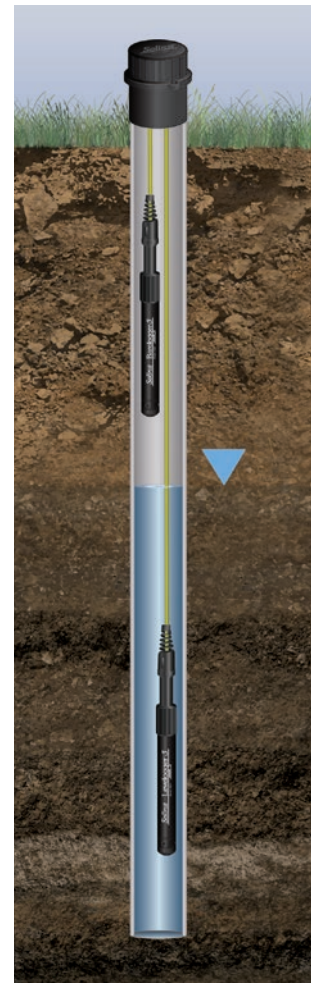
Installation mit einem direkten Auslesekabel eines Barologger 5 und eines Levellogger 5 in einem Brunnen
