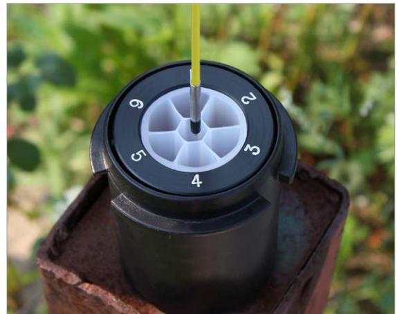
Messung der Wasserstände in den engen Kanälen eines Solinst CMT®-Systems.
